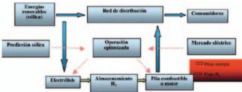
Figura 14. Sistema energético integrado en la red eléctrica.
